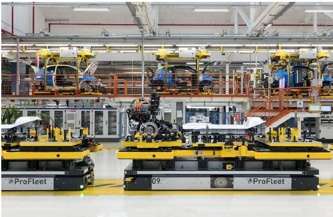
CPM - AGV ProFleet nello stabilimento di Mirafiori per 500 BEV
