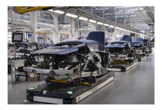
Un AGV ProFleet CPM – Dürr in azione nello stabilimento Maserati di Modena dove viene costruita la supercar MC20
