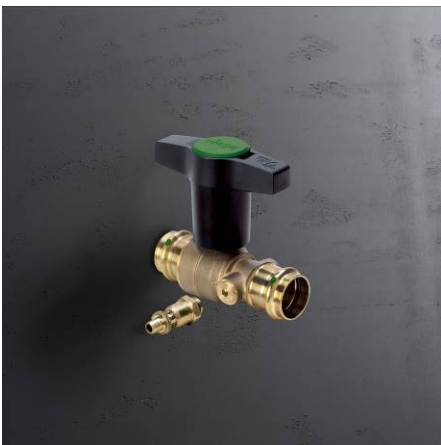
IT_PR_220628_Viega_Easytop_003.jpg: Valvola a sfera di bronzo Viega Easytop con SC-Contur, estremità a pressare femmina e o-ring di EPDM, con attacco G 1/4" per l'innesto di una valvola di campionamento (foto: Viega)
