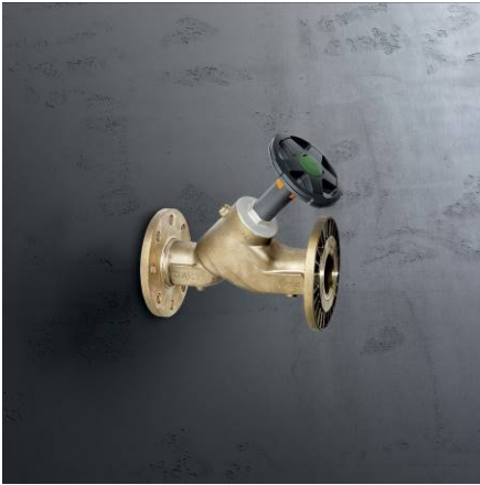
IT_PR_220628_Viega_Easytop_002.jpg: Valvola inclinata Easytop XL con corpo di bronzo e sede di acciaio inossidabile con marchio di conformità DVGW, con attacco flangiato e punti di innesto G 1/4" o G 3/8" (foto: Viega)
